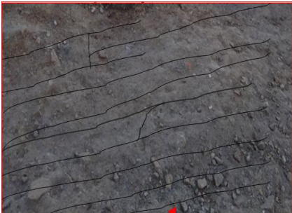
صفحي، صفائحي (صخر يكون في جبل على شكل طبقات بعضها فوق بعض Feuilleté تستخدم في بناء الجدران، وخاصة لواح يثنية وقائمة
